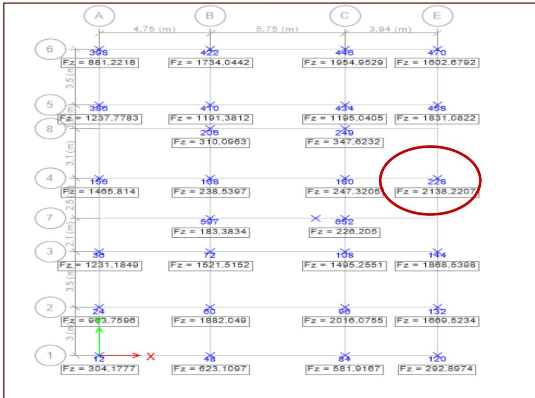
Figure II.4 Résultat de la descente des charges
