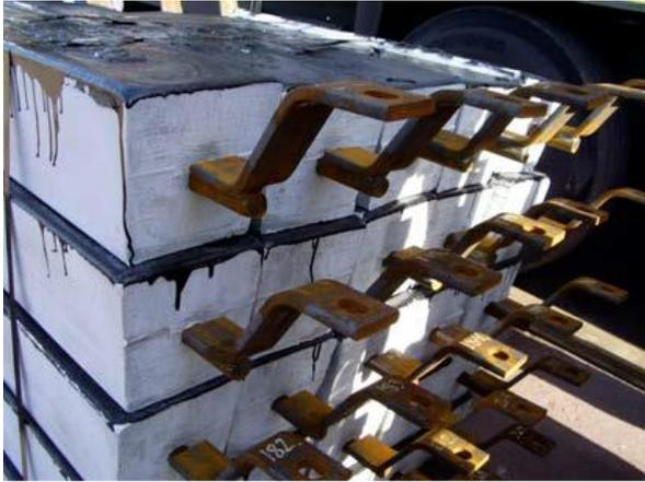
**Figure II. 4:** Anodes sacrificielles
