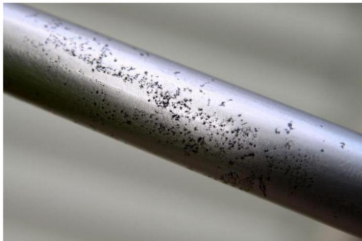
**Figure I. 7 :** Piqûration d'une barre d'acier
