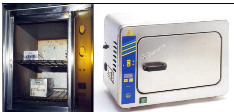
Figure 3-1 Intérieur et extérieur d'un four de type PoupinelND
