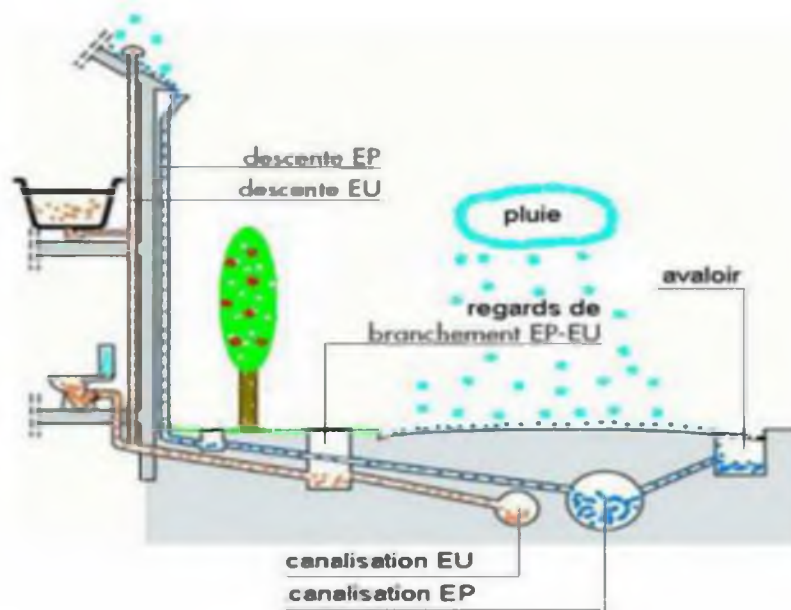
Figure I-5 : Schéma d'un réseau séparatif [Certu 2003].
