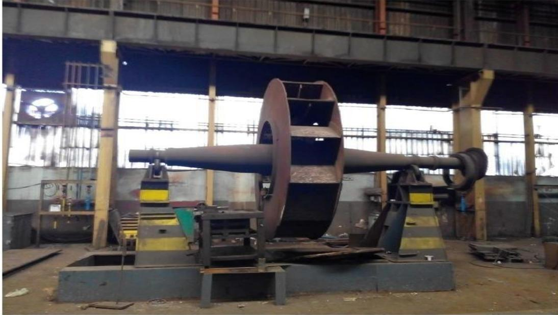
Figure IV.1: la turbine lors de l'équilibrage sur machine
