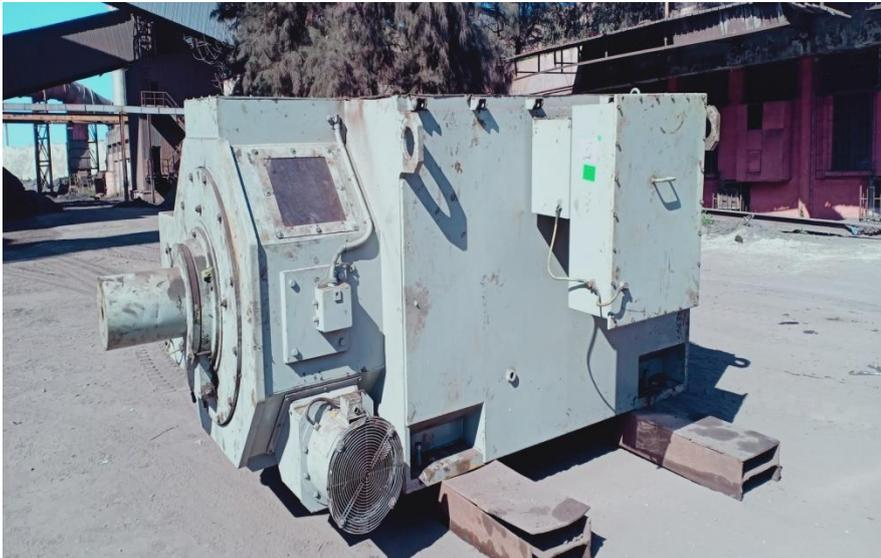
Figure. IV.2 : moteur asynchrone à bague
