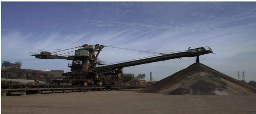
Figure I-3: Processus d'homogénéisation à l'aide d'un jeteur.
