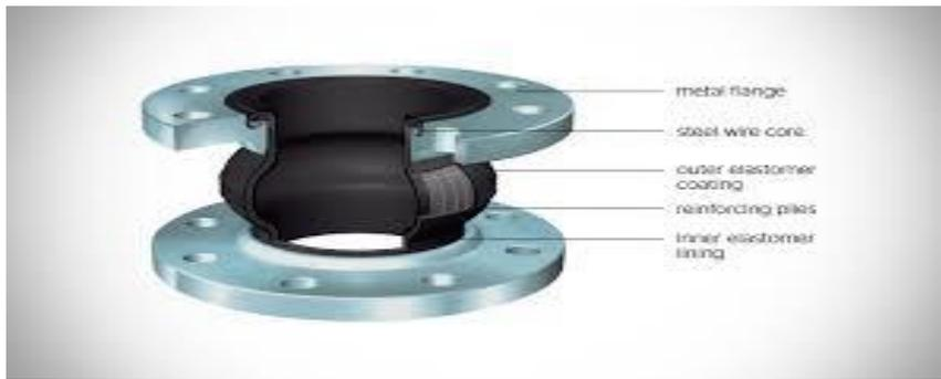
Figure III.6 : joint de dilatation
