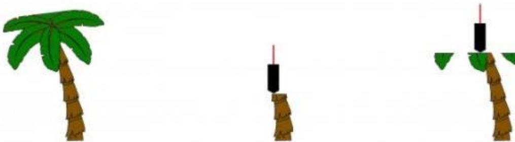
**Figure 7 :** impression couche par couche d'un palmier
