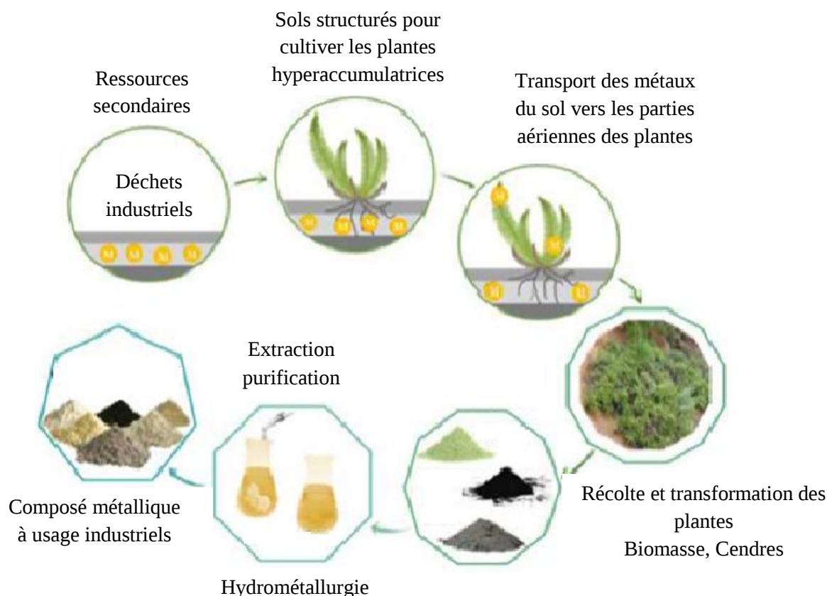
Figure. III.7. Schéma du procédé de transformation pour produire des métaux.[20]
