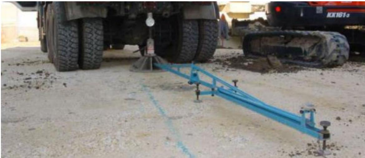
Figure VIII.5 : Essai de plaque
