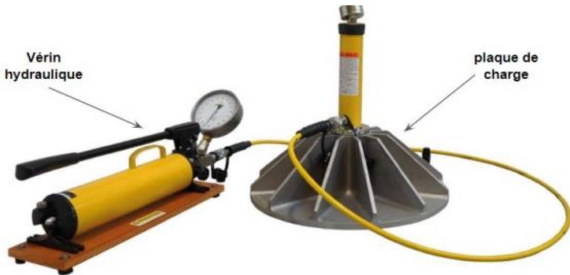
**Figure VIII.7 : Vérin hydraulique et plaque de charge**
