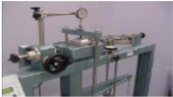
Figure VIII.4 : Essai de cisaillement à la boîte
