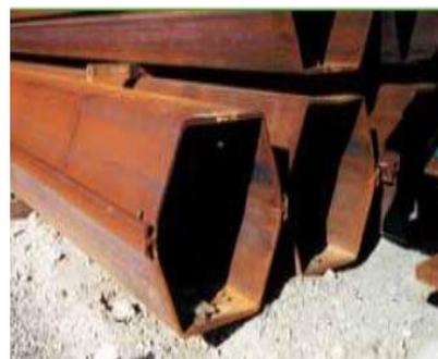
Figure I.11. Palplanches laminée à chaud[8]
