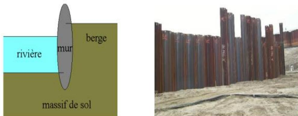
**Figure I.03a): Schéma de principe du mur de palplanches b) Assemblage des éléments [1]**
