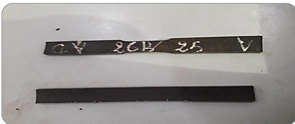
Figure 32 : Languette et Eprouvette plate de traction de l'acier API-X52
