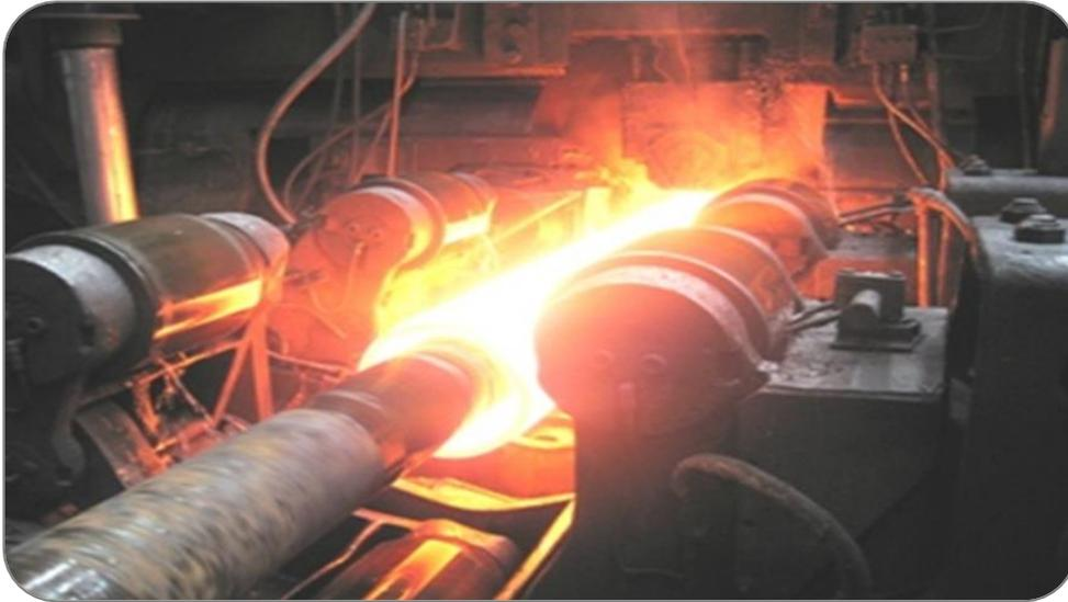
**Figure 18** : Emprise de l'ébauche entre le mandrin de perçage et les cylindres obliques d'une part et les guides inférieur et supérieur d'autre part
