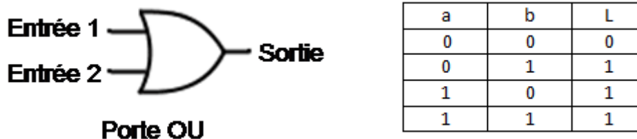
Figure III.2 : symbole et table de vérité de la porte OR
