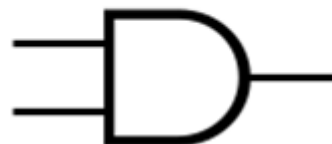
Figure III.1 : Table de vérité et symbole du porte AND
