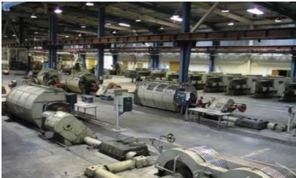
**Figure II.12.** Tréfileuse à glissement horizontal, de type UDZ WG 1250/10 gi-F
