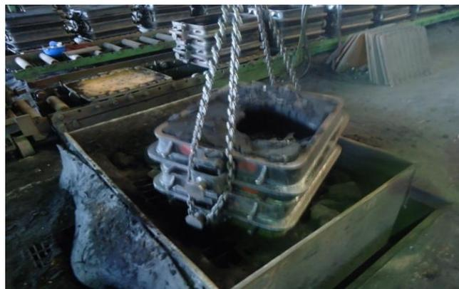
**Figure 06:**Station de décochage par vibration
