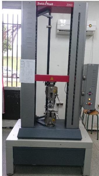
Fig III.1 : Machine de traction.
