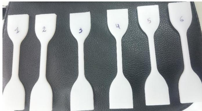
Fig III.16 : les éprouvettes pour l'essai de traction
