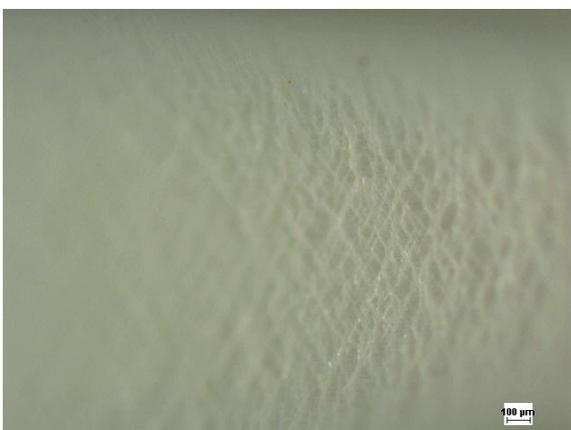
Fig III.42 : Surface de PE d'épaisseur 5mm (x50)
