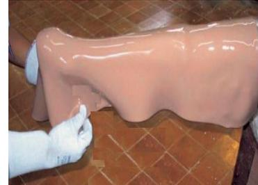
Fig I.14 : Plaque chaude positionnée sur le moule plâtré
