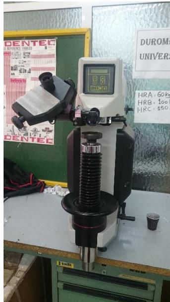
Fig III.52: Machine de dureté Rockwell Zwick 5113
