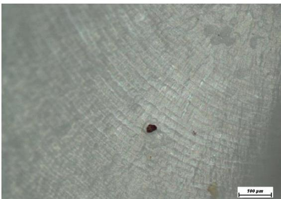
Fig III.50 : les impuretés sur la surface de PP d'épaisseur 4mm (x100)
