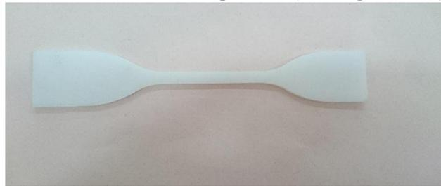
Fig III.4 : L'éprouvette
