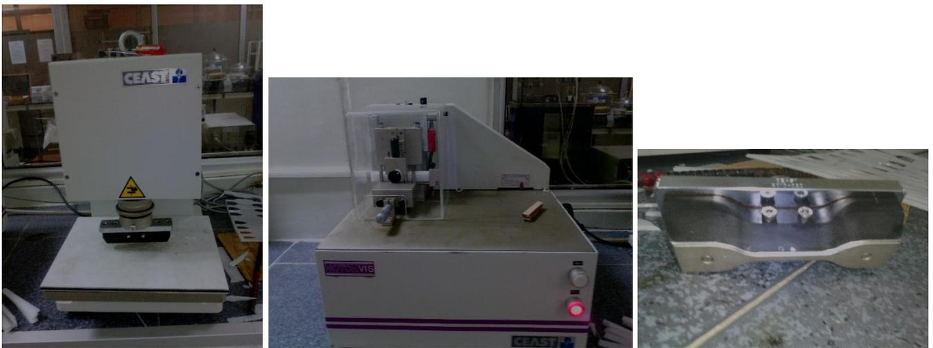
Fig III.8: Machines de CEAST ASTM D-1922 et machine d'entailleuse ASTM D-256 avec le moule de l'éprouvette
