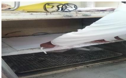
Fig I.13 : plaque thermoplastique sur le four
