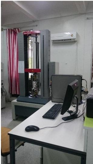
Fig III.15: machine de traction Zwick/Roell Z050 pilotées par ordinateur
