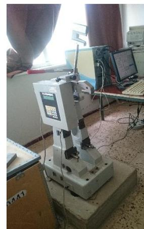
Fig III.11 : machine de choc Zwick/Roell 5113
