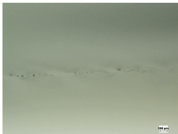
Fig III.43 : Surface de rupture d'épaisseur 5mm (x50)
