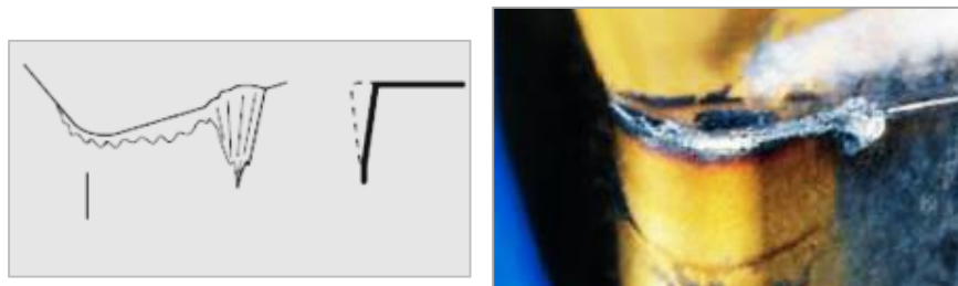
Figure I. 11 : Usure en entaille [17].
