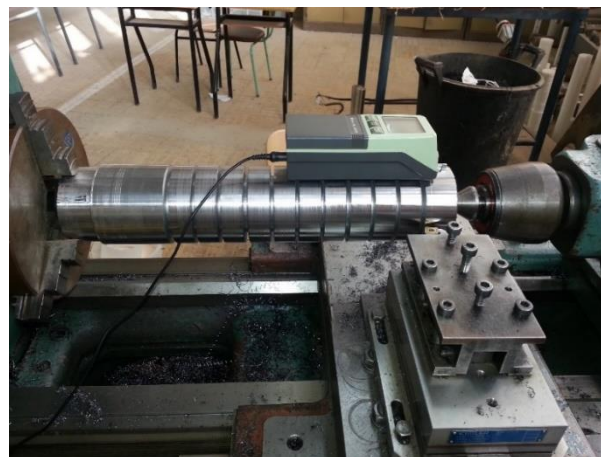
Figure II. 3 : Représentation de l'éprouvette en montage d'usinage pour les essais des efforts de coupe et rugosité sur un tour SN 40.
