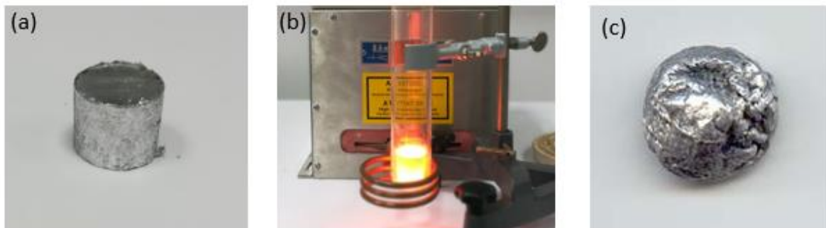
Figure II.6 : (a) Pastille Al-Nb, (b) Alliage Al-Nb en fusion, (c) Échantillon d'alliage à base d'Aluminium après fusion HF
