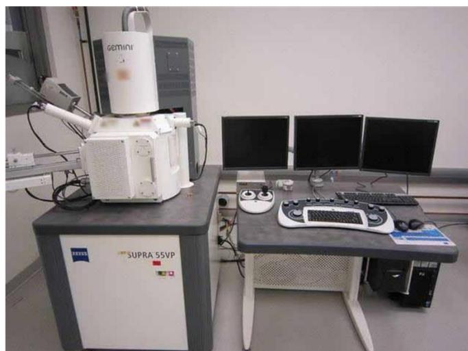
**Figure 11:** Microscope électronique à balayage (MEB) utilisé pour l'observation des lithiases à l'échelle mésoscopique (200nm à 200µm)
