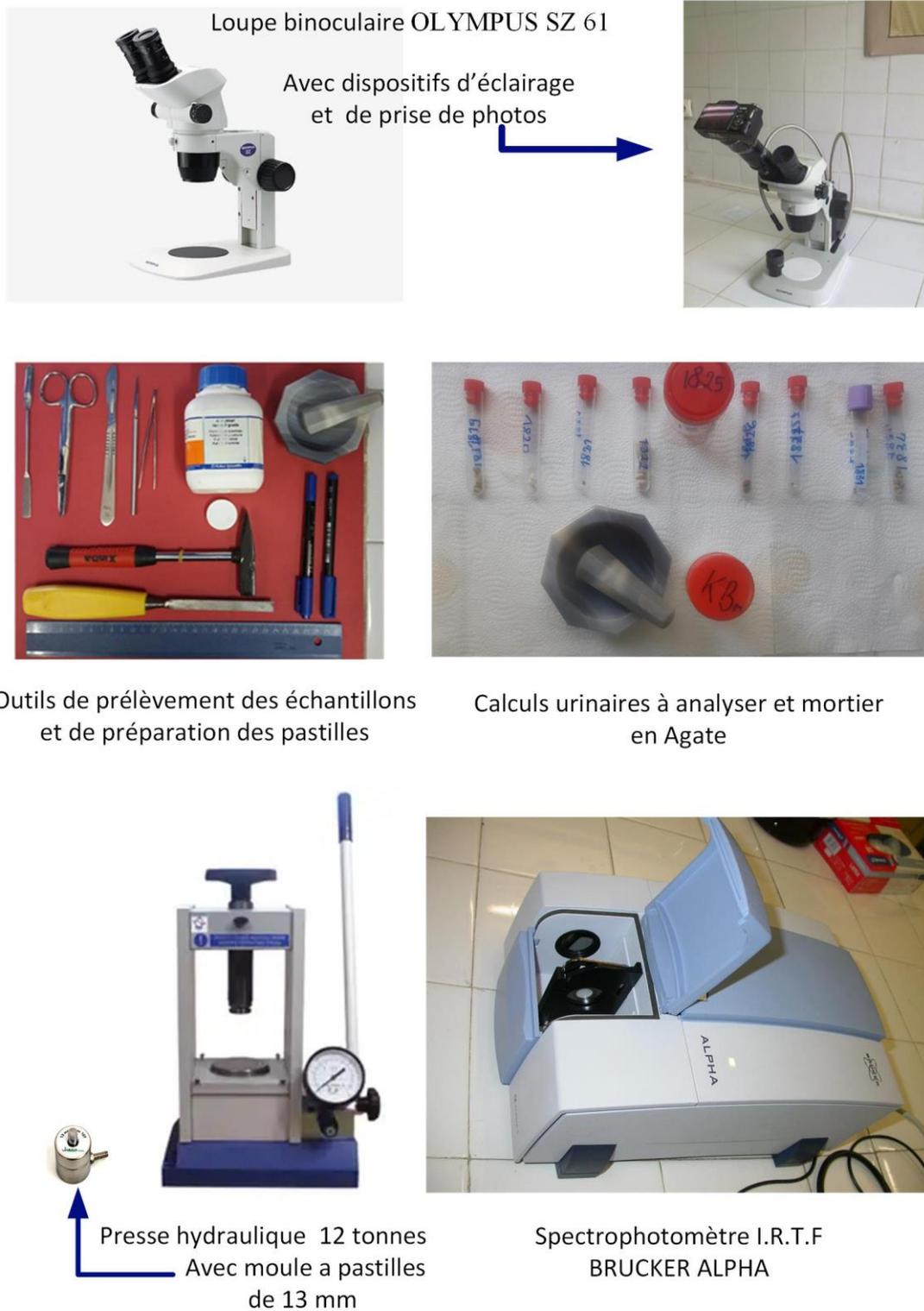
**Figure 10:** Matériel et accessoires utilisés dans les analyses morphologiques et infrarouge des calculs urinaires
