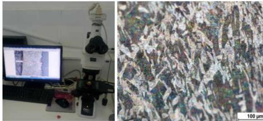
Figure III.11. Morphologie du copeau lors du perçage au régime N°6 après trempe V_c=25,12 , f=0,10 et D=20
