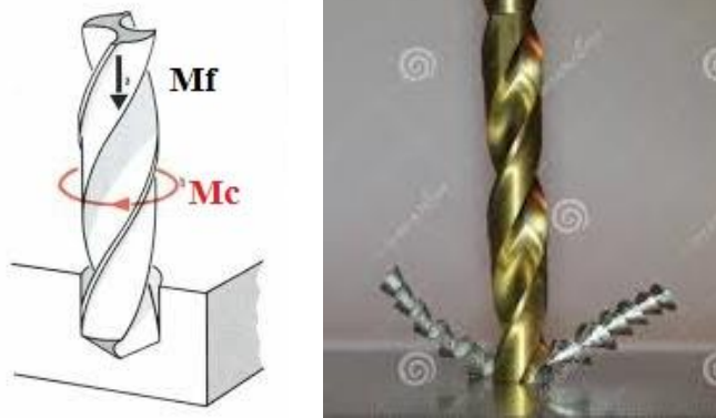
Figure I.39. Illustration du mouvement de coupe ( M_c ) et celui d'avance ( M_a ) en perçage [60]
