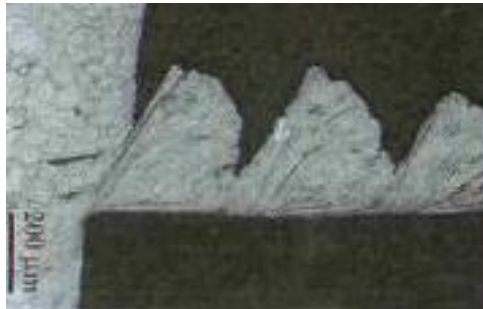
Figure I.15 : Copeau discontinu cas d'un acier austénitique inoxydable usiné avec un outil carbure ( V_c = 130\text{m/min} , f = 0,1\text{mm/tr} ) [42].
