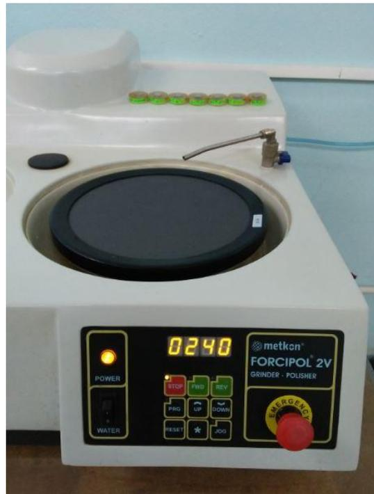
Figure II.6 : Polisseuse modèle metkon type *FORCIPOL 2V*.
