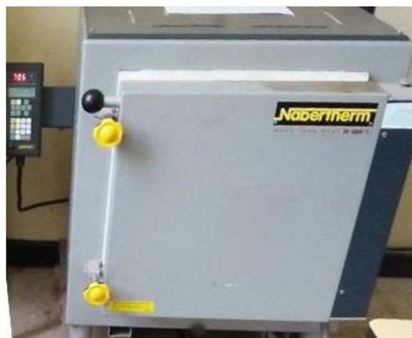
**Figure II.4 :** Four marque Nabertherm type *LH60/12* pour les traitements thermiques.
