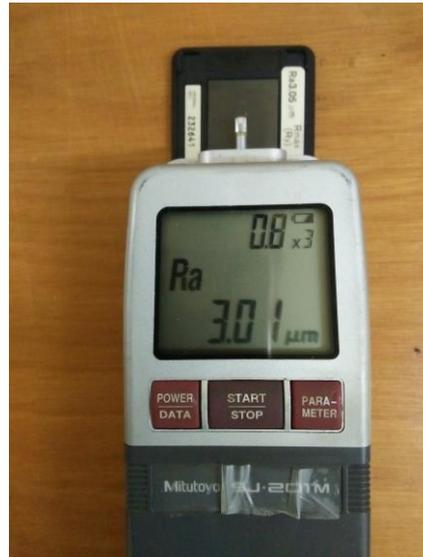
**Figure II.12** : Appareil de mesure de la rugosité modèle Mitutoyo Surfptest SJ-201M.
