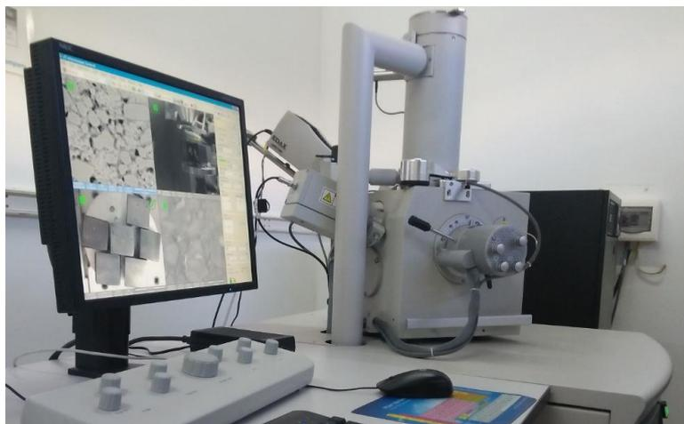
**Figure II.8** : Vue de l'arrangement *MEB* avec *EDS* modèle *Quanta 250*.
