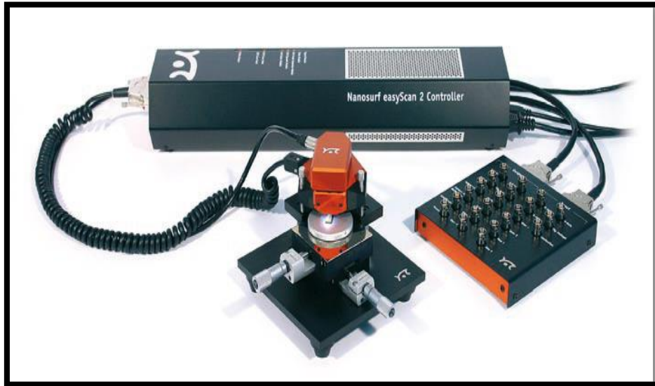
Figure III.15 : Microscopie à force atomique (AFM) de marque Nanosurf easyScan 2.
