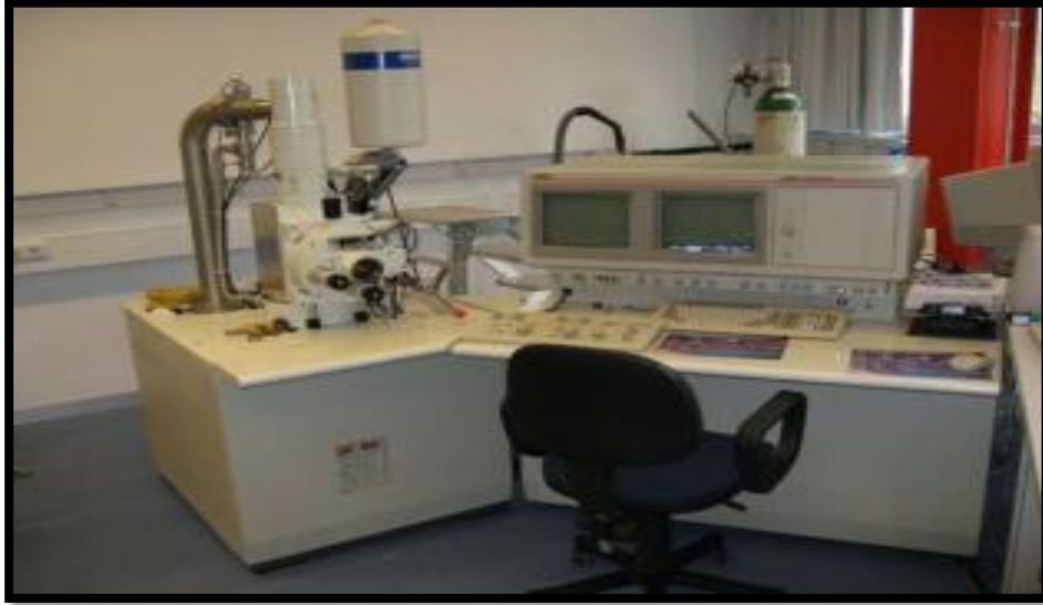
Figure III.14 : Microscope électronique à balayage de type Jeol JSM-6400.
