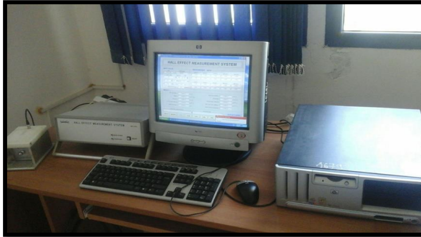
Figure III.20 : Dispositif des mesures électriques par effet Hall.
