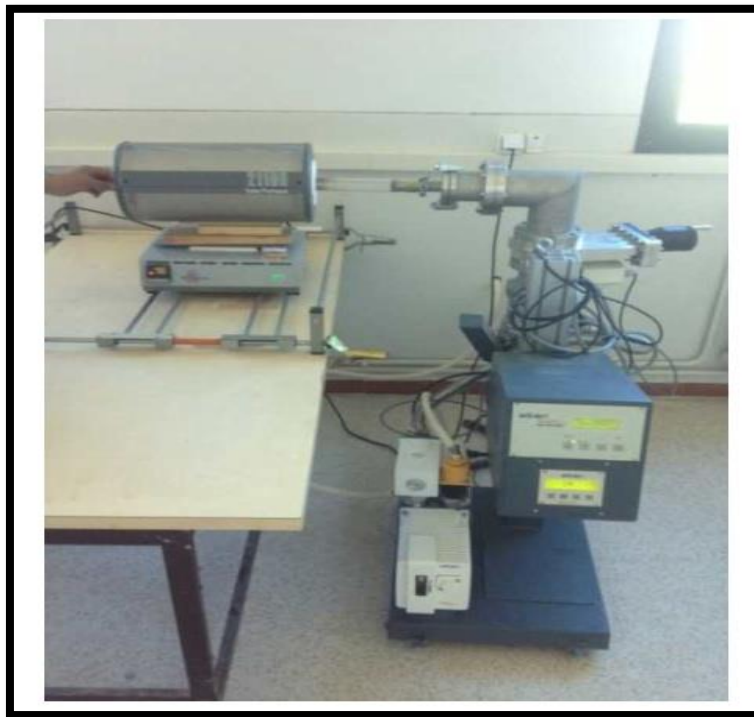
Figure III.7 : Photographie du four à recuit sous vide.
