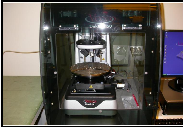
Figure III.9 : Profilomètre de marque Veeco (Brüker) de type Dektak 150.
