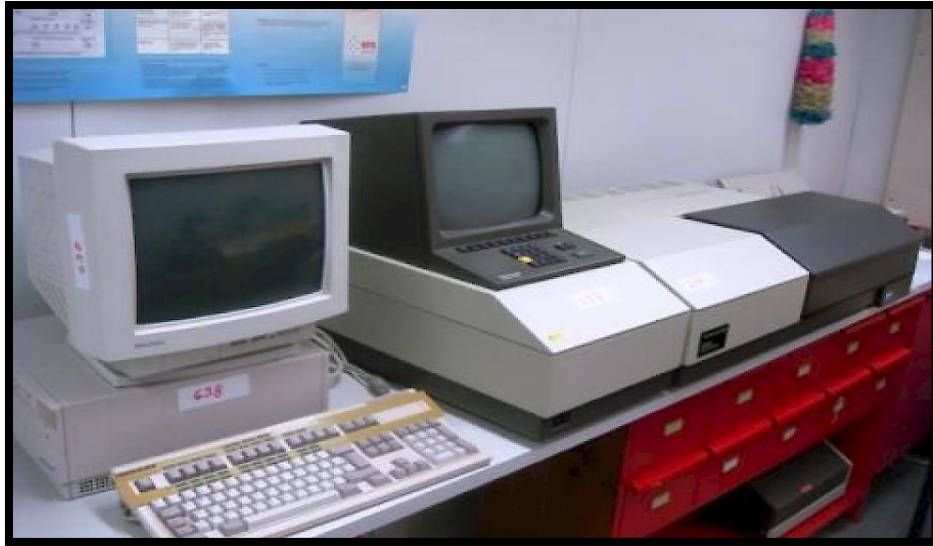
Figure III.18 : Spectrophotomètre UV-Vis de marque Perkin-Elmer de type Lambda 9 (UV-Vis-NIR).
