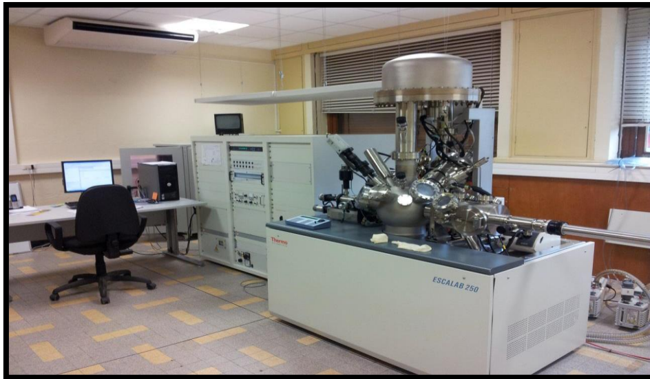
Figure III.13 : Spectromètre XPS ESCALAB 250 de Thermo Electron Corporation.
