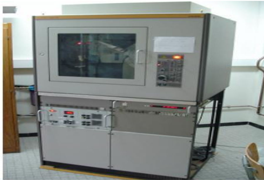
Figure II-4: Diffractomètre D-500 à anode de cobalt (IPCMS)
