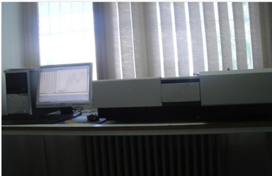
Figure II.8 : Spectrophotomètre Elmer Lambda 950 spectromètre
