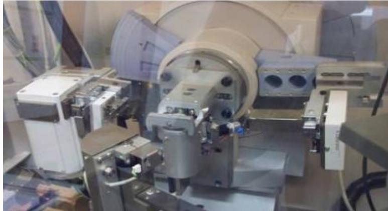
**Figure III.11.** Diffractomètre Panalytical X'Pert Pro de type Bragg-Brentano.
