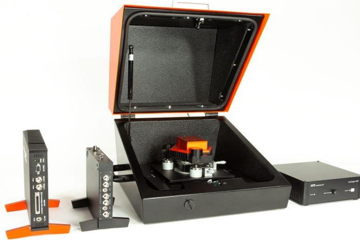
*Figure III.18. Photographie du système Nanosurf Flex-AFM.*
