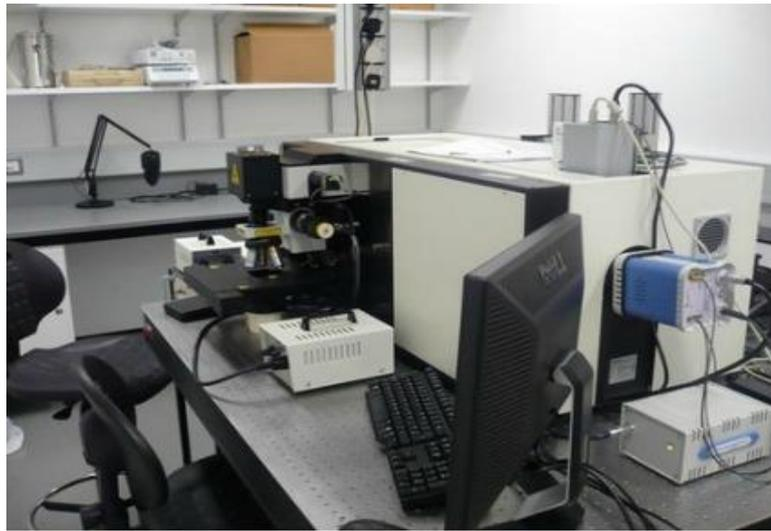
*Figure III.13. Spectrophotomètre Raman Horiba Jobin Yvon LabRAM HR 800.*
