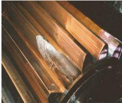
Figure I. 2: Défaut de cassure de dent [8]
