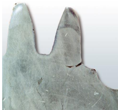
Figure I. 7: Fissure de fatigue dans le profil du pied de la dent d'engrenage [16]
