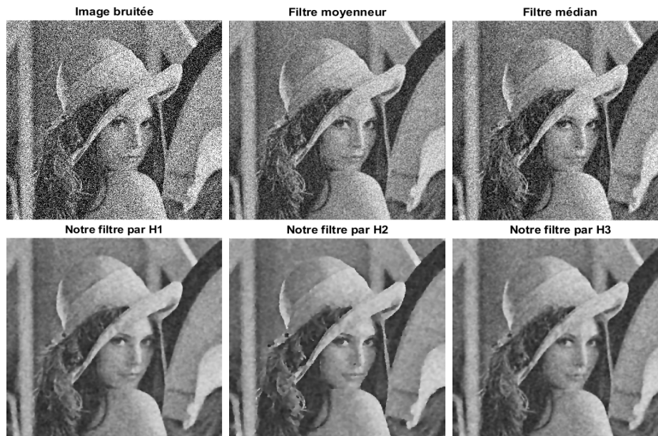
FIGURE 4.4 – Comparaison des résultats entre le filtre moyenneur, médian et nos trois fonctions sur une image naturelle bruitée avec un bruit gaussien de moyenne m = 0 et de variance v = 0.05 , le nombre d'itérations est égal à 20.
