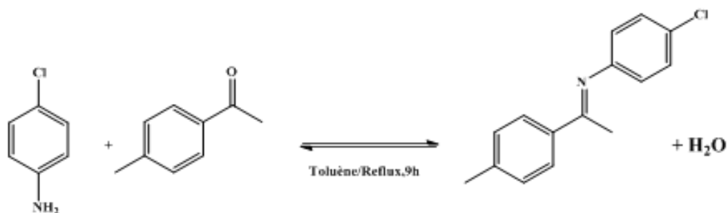
Figure 23 : Condensation de para-acétophénone et de la parachloroaniline
