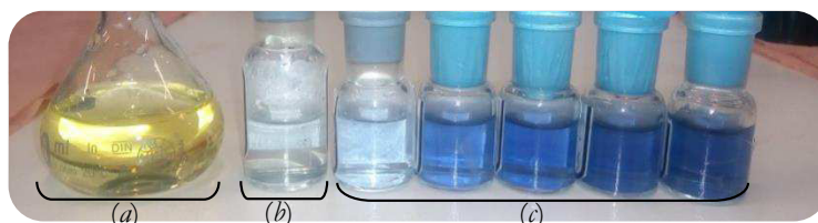
Figure II.2 – Dosage de phosphate avec le réactif, (a) le réactif, (b) le blanc, (c) les solutions filles.
