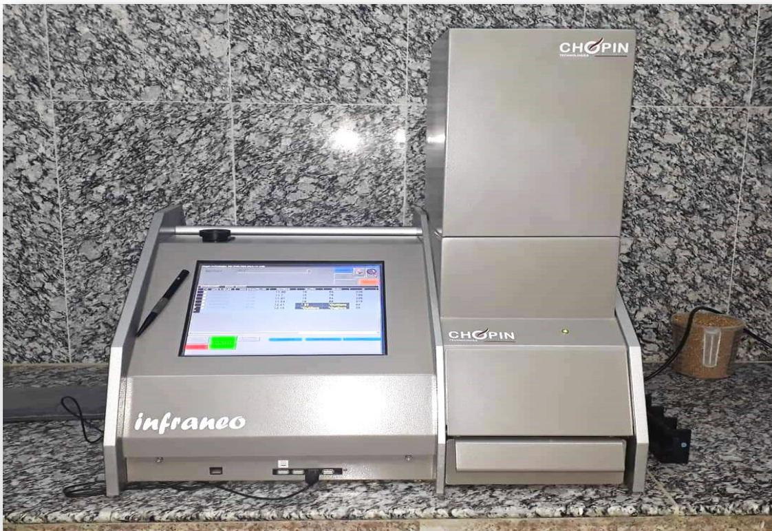
Figure 2. Appareil Chopin de type Infraneo (Photo personnelle).
