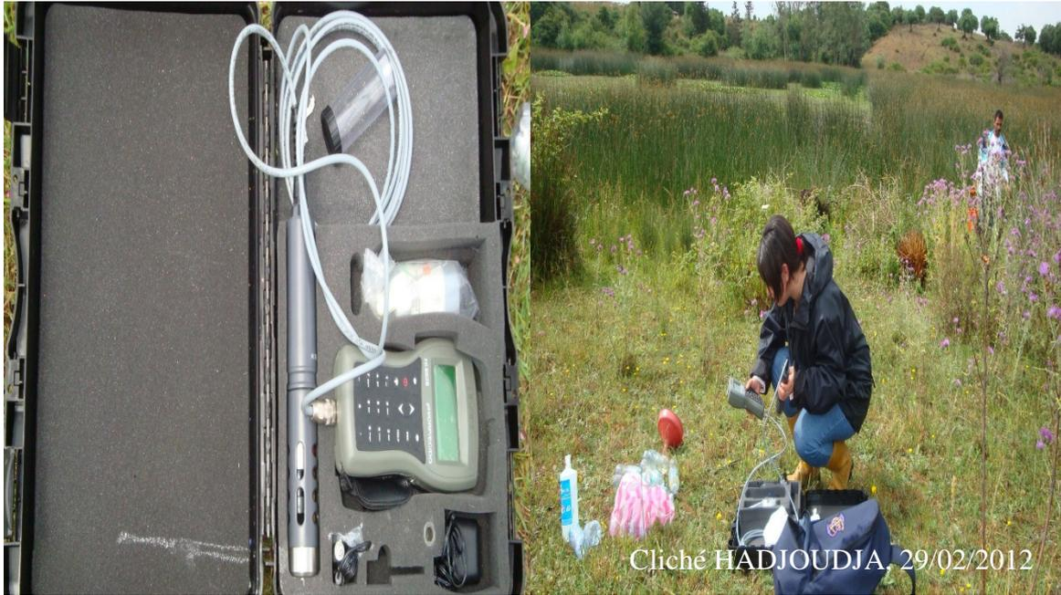
**Figure 21** Valise multi-paramètres de terrain étanche portatif à microprocesseur de type HI 9024 C
