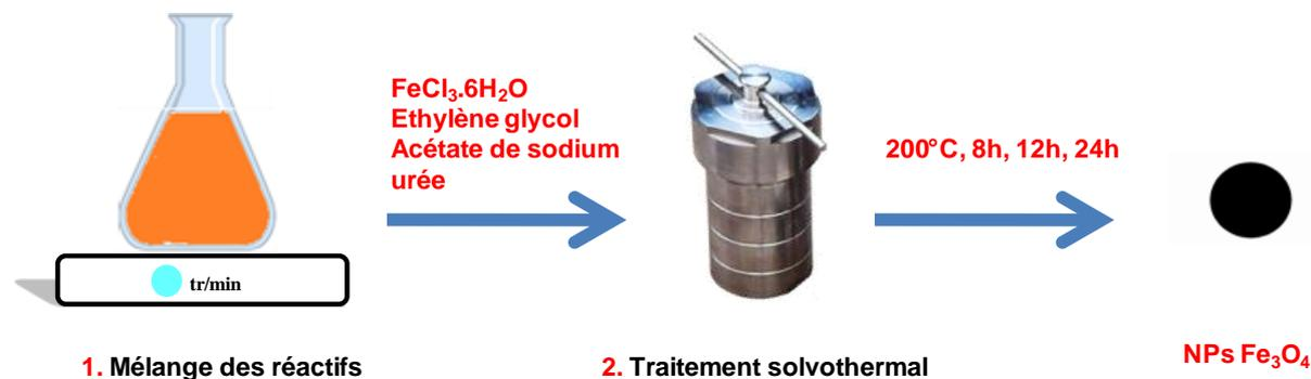
**Figure 2.6 :** Schéma simplifié regroupant les étapes de synthèse des particules magnétiques par la méthode solvothermale.
