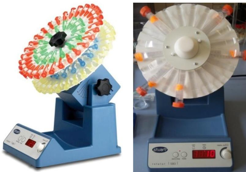
**Figure 2.10** : Tests in vitro de libération de PA en utilisant la roue d'agitation.
