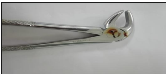
Figure I.12. Pince orthodontique après 12 cycles de stérilisation.
