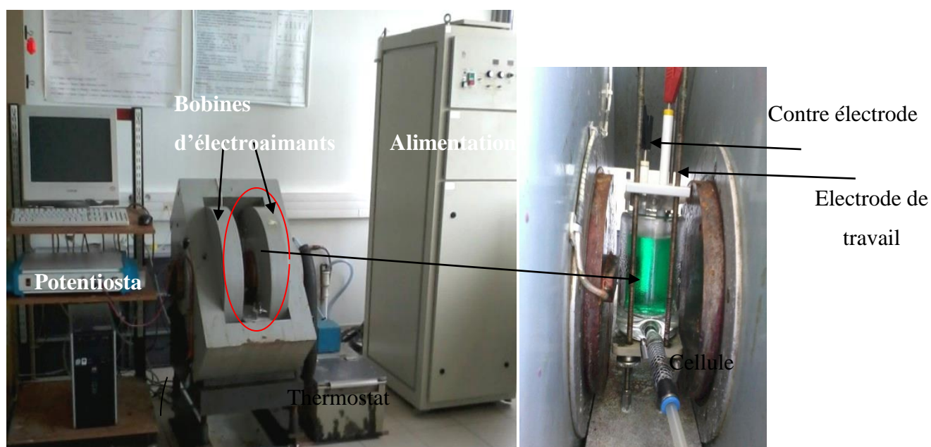
Figure. III.7. Photographie du montage d'électrodeposition et la cellule électrochimique en appliquant un champ magnétique.
