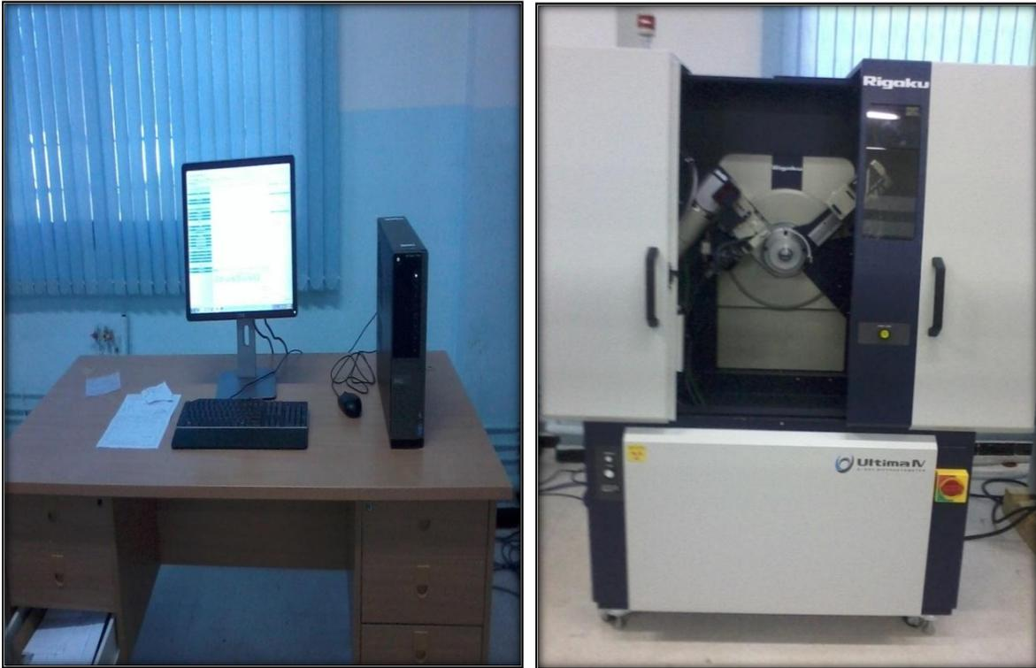
*Figure III.17. Diffractomètre du type Rigaku Ultima IV.*
