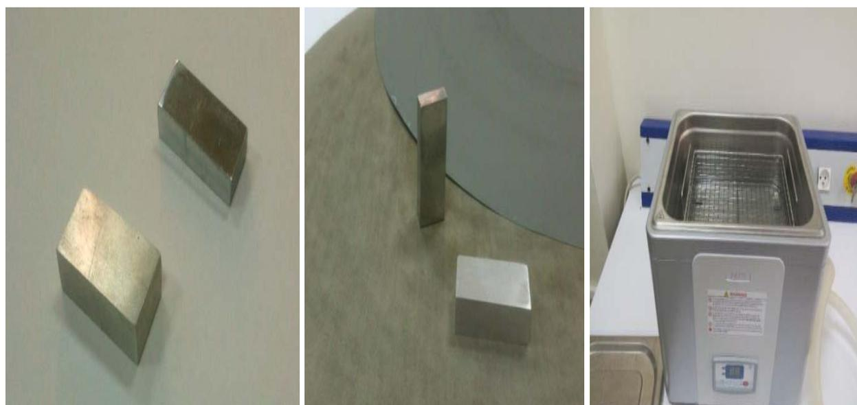
*Figure III.1. Pièces découpées puis polies par papiers abrasifs et nettoyer par Bain à ultrason.*
