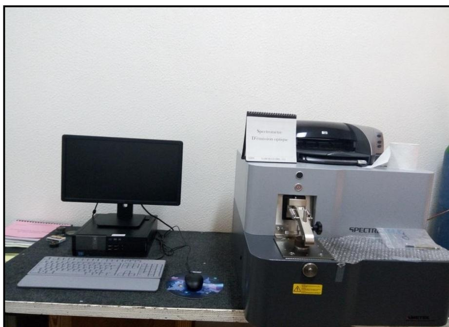
**Figure III.2.** Spectrophotomètre d'émission optique type *SPECTRO*.
