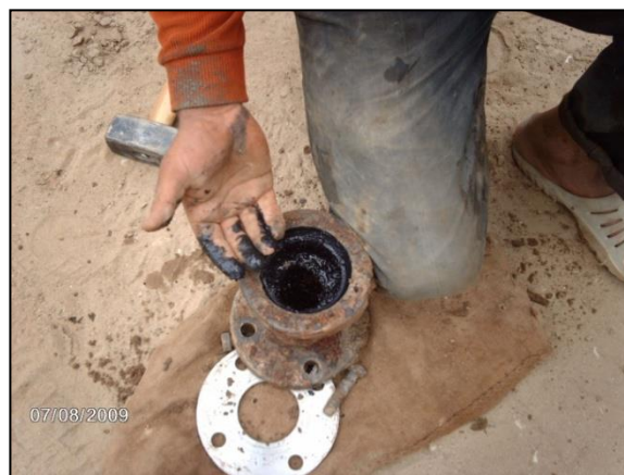
Photo 3.6 : Échantillon prélevé lors de la rénovation du réseau d'AEP ville de S/Ahras, Caractéristiques de matériau : tronçon de 50 cm en fonte ductile (DN100mm ep7mm).
