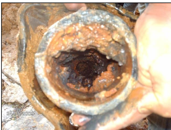
Photo 3.6 : Échantillon prélevé lors de la rénovation du réseau d'AEP ville de S/Ahras, Caractéristiques de matériau : tronçon de 50 cm en fonte ductile (DN100mm ep7mm).
