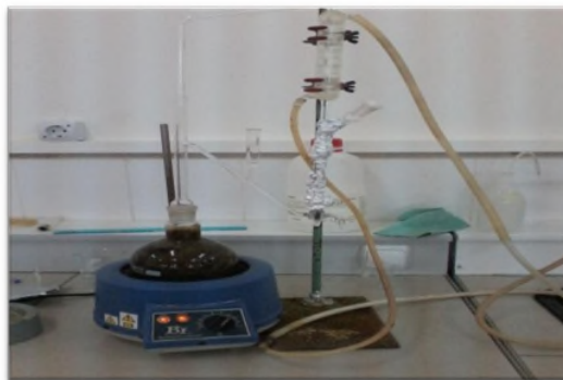
Photo 3. Dispositif d'extraction de l'HE par hydro-distillation (Labo. Chimie analytique)
