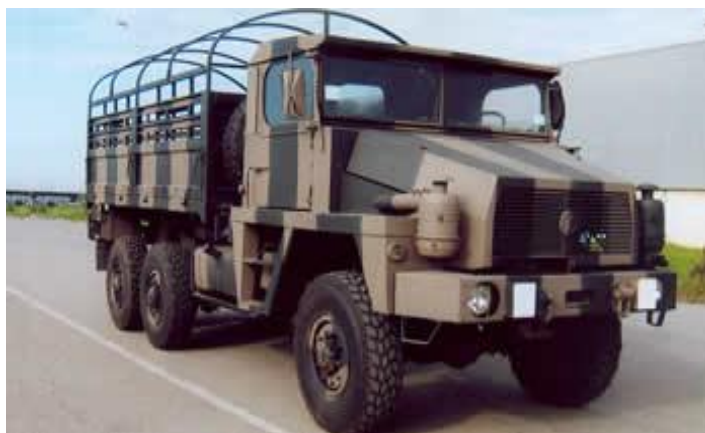
Figure III. 1 : Camion SNVI M 230 (6 cylindres de 230 chevaux)
