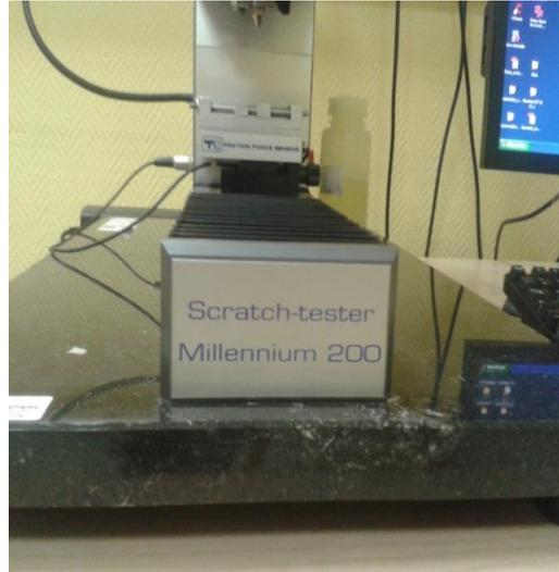
**Figure II.25.** Dispositif de scratch-test CER Arts et Métiers Lille.
