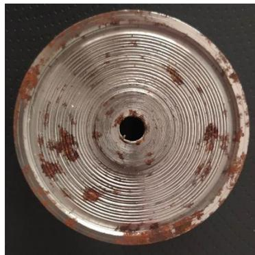
Figure II.2. La surface de l’acier Z200C12 après l’usinage
