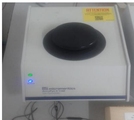
**Figure II.22.** Pycnomètre à gaz Micromeritics AccuPII, série 1430 utilisé pour la mesure de la porosité.
