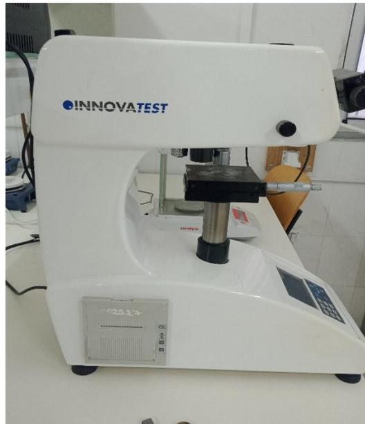
Figure II.23. Microduromètre Vickers INNOVATEST 412D.
