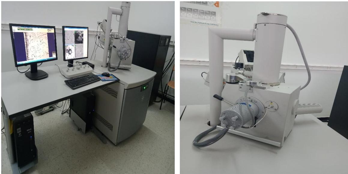
**Figure II.17.** Microscope électronique à balayage type QUANTA 250.
