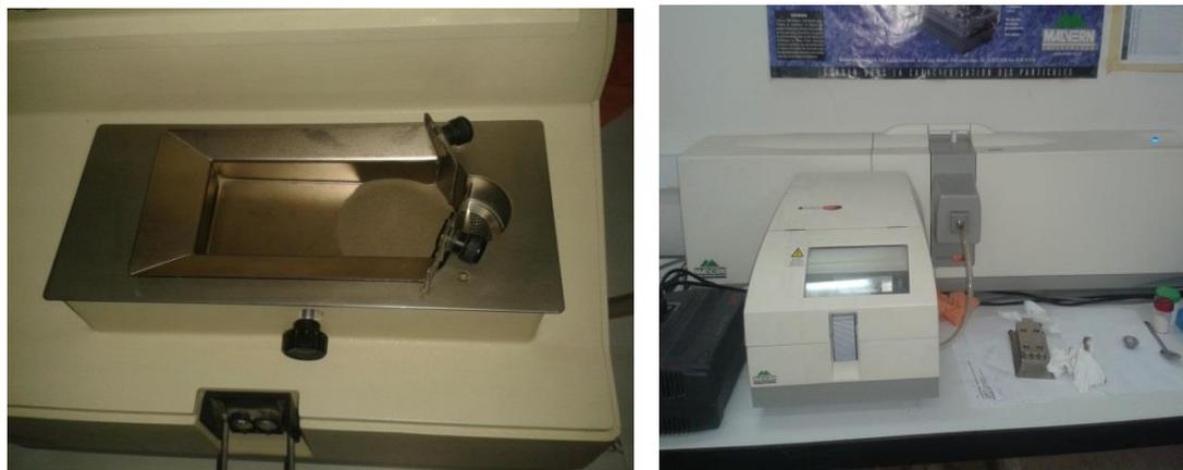
**Figure II.4.** Diffractomètre laser Mastersizer 2000.
