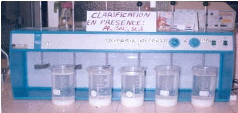
Figure III.2 : Photo du flocculateur à 6 postes utilisé (Jar-Test)
