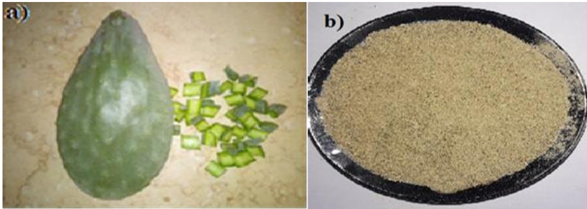
Figure III.3. Cactus naturel coupé (a) séché, broyé et tamisé (b)
