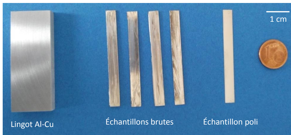
Figure II-8 : Photo montrant le lingot initial, les lames après découpage et l'échantillon après polissage.
