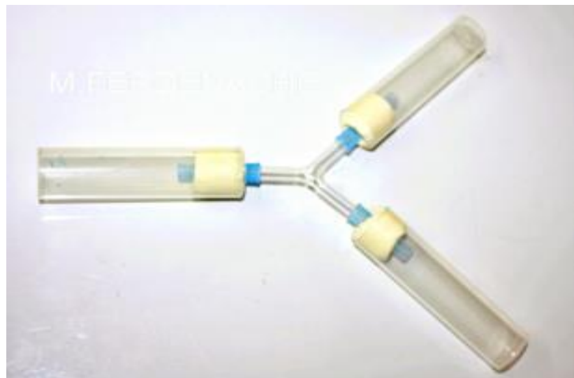
Figure 14. Olfactomètre en Y utilisé pour l'étude de l'orientation des mouches vers des odeurs.
