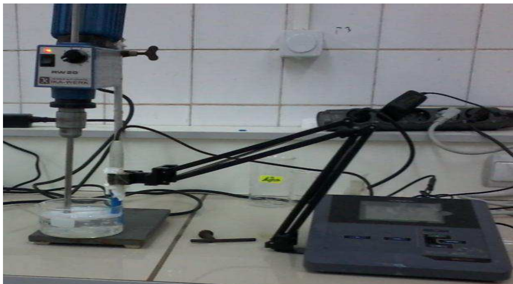
Figure II-7. Appareillage expérimental pour l'étude de la stabilité des émulsions
