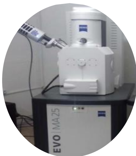
Figure III.11. Microscope électronique à balayage couplé à l'EDS
