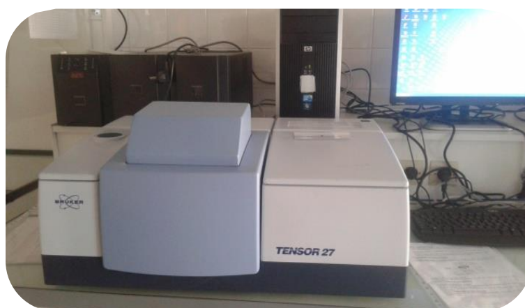
Figure III.10. Modèle de spectroscope infrarouge à transformée de Fourier utilisé
