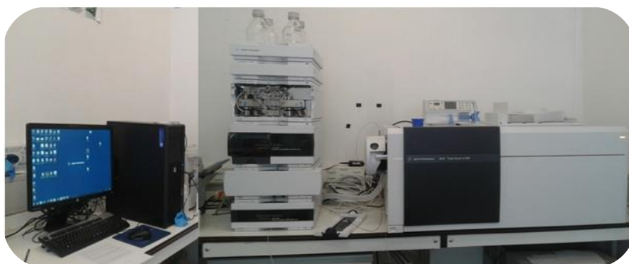
Figure III.8. Chromatographie en phase liquide couplé à la spectrométrie de masse
