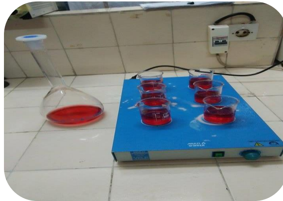
Figure III.13. Dispositif d'adsorption batch employé
