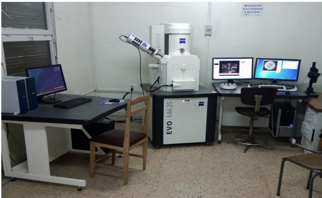
**Figure V. 12.** Microscope électronique à balayage avec EDS.
