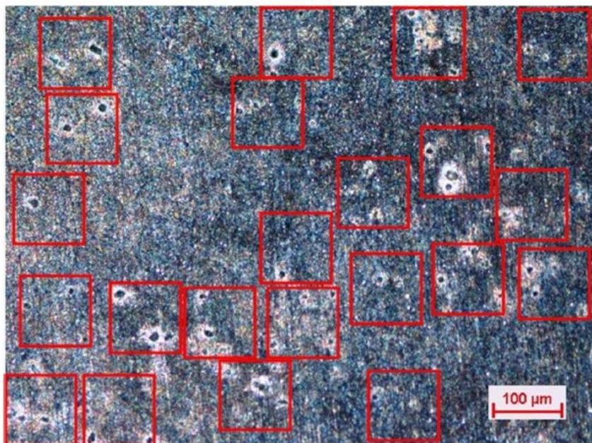
**Figure VI. 6.** Puits de corrosion après 56h d'immersion avec une densité de 622 piqûres /  $\text{mm}^2$  dans 3.5% NaCl.
