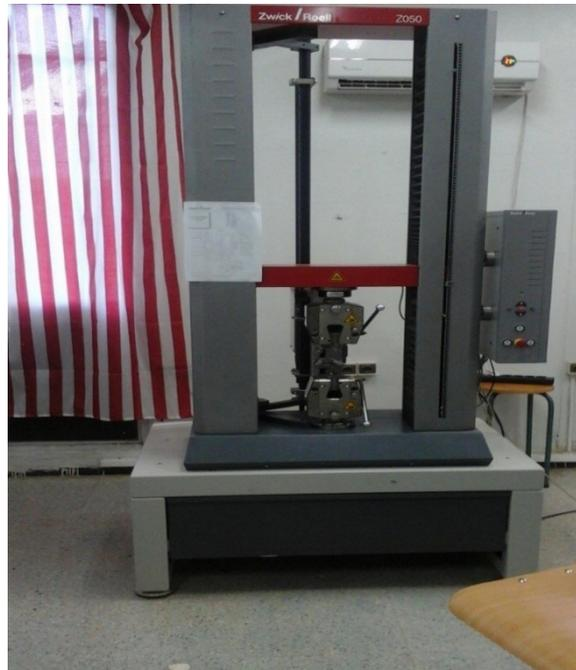
**Figure V. 3.** Machine de traction de type Z050.
