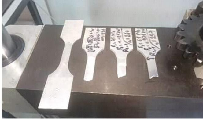
Figure V. 6. Epreuve de fatigue après rupture.
