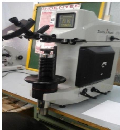
Figure V. 8. Duromètre Zwick/Roell ZHU.
