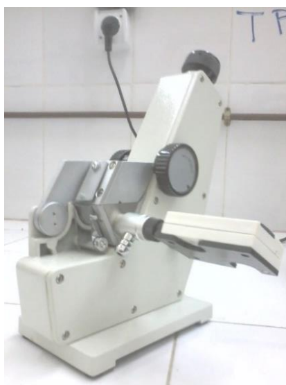
Figure III.8 : Réfractomètre type ABBE.
