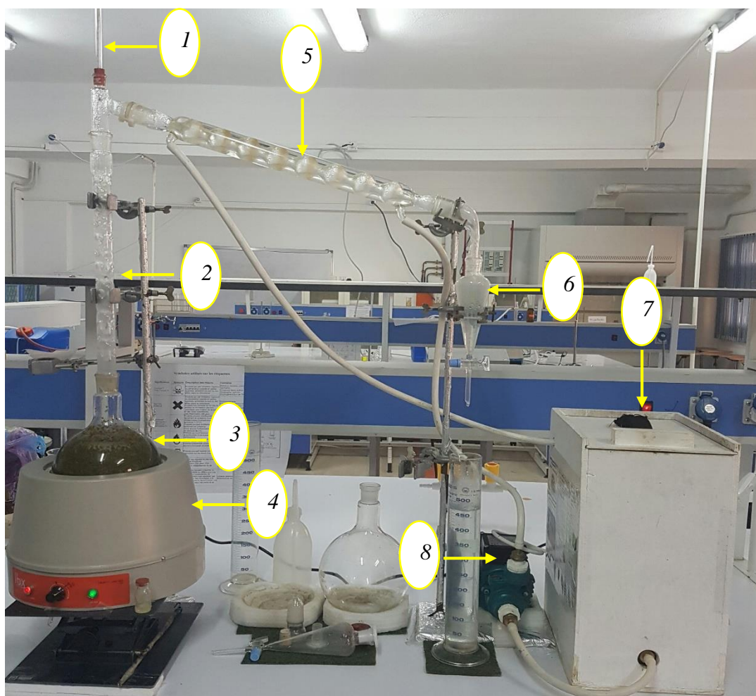
Figure III.7 : Montage de l'hydrodistillation mise en place ( Clevenger ).
