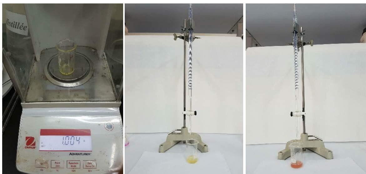
Figure III.9 : Dispositif de mesure de l'indice d'acide.
