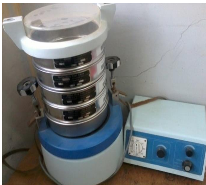
Figure III.5 : Tamiseur vibrant ordinaire (GB/T600 3.1-1997).
