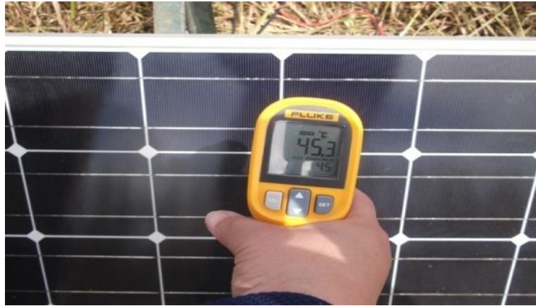
Fig. IV.15. Mesure de la température interne du module photovoltaïque
