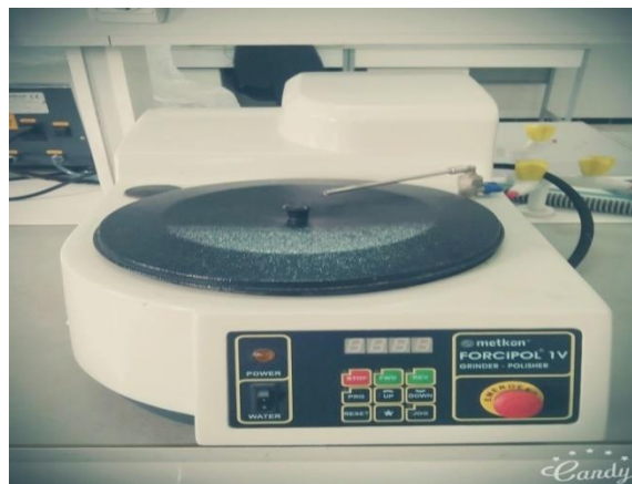
Figure II.3 : Polisseuse mécanique de type metkon forcipol 1V.
