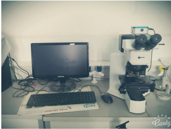
Figure II.5 : Microscope optique de type de Nikon LV100 (URASM Annaba)
