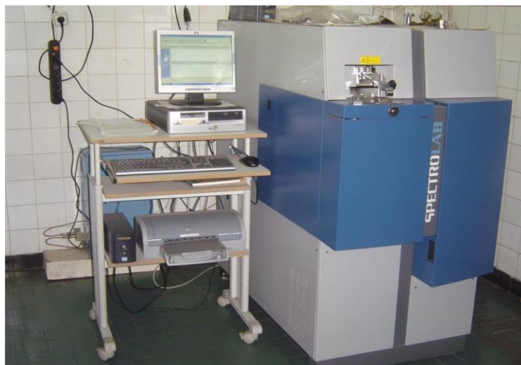
Figure II.1 : Spectromètre Spectrolab utilisé pour l'analyse chimique.
