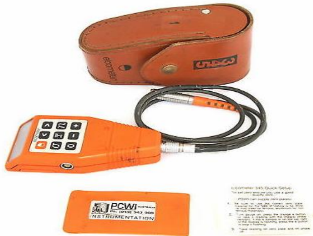
Figure II.4 : Elcometer 345 utilisé pour le contrôle de l'épaisseur
