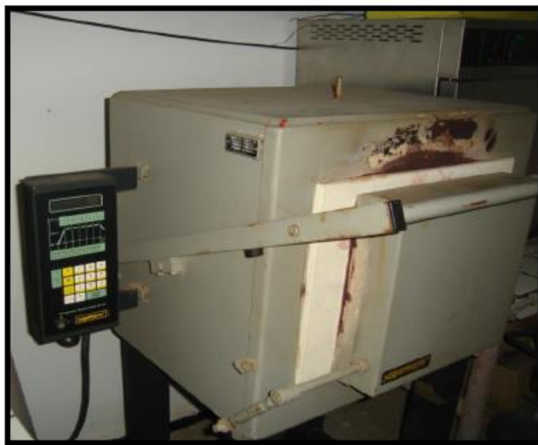
Figure III.6 : Four programmable de type (Nabertherm-Allemagne).
