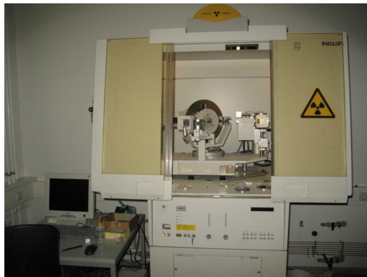
Figure II.19 : Diffractomètre de type Philips PW 3710 (Laboratoire des Ressources Minérales, Département de Géologie, Faculté des Sciences de Tunis).
