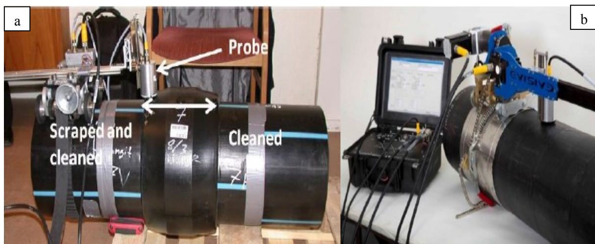
Figure 1.22 : Technique de CND par Micro-onde a) Soudure par EF et b) soudure bout à bout [41]
