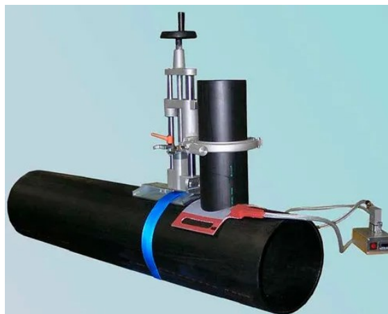
Figure 1.9 : Equipements du soudage par fusion à selle
