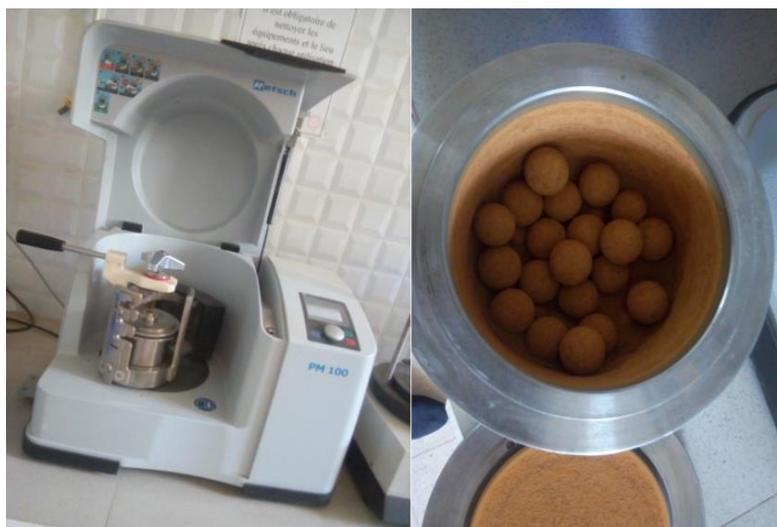
**Figure.III.6** Broyeur type RETSCH pour le broyage des échantillons
