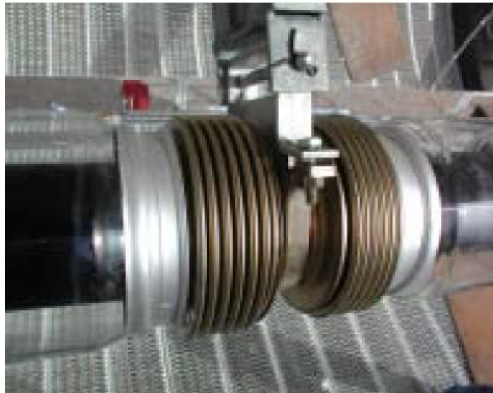
Figure 2. 6: plan de la fixation du support du récepteur sur le tube absorbeur [76]
