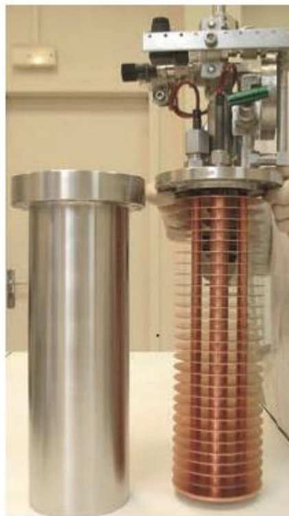
Figure 2. 12: assemblage des disques d'hydrure de magnésium [78]
