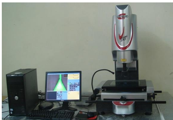
Figure II.9: Microscope utilisé pour la mesure de la fissure
