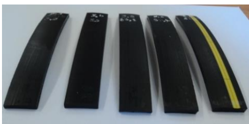
Figure II.8b: Forme et dimensions des éprouvettes SENT
