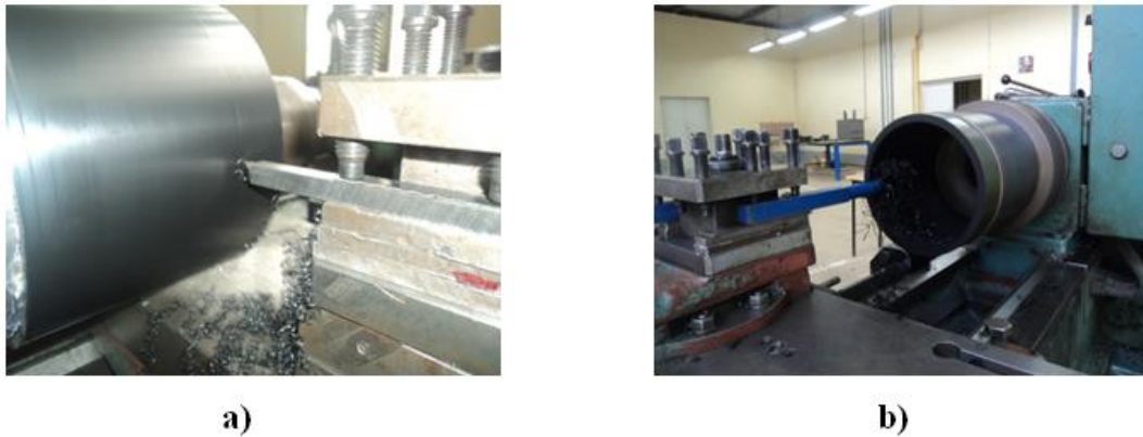
Figure II.4: Opération de tournage du tube en HDPE-100:
